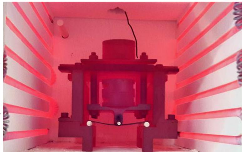
Module de flexion à haute température.
