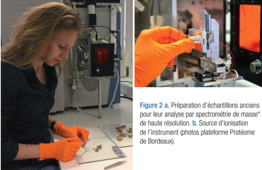
**Figure 2 a.** Préparation d'échantillons anciens pour leur analyse par spectrométrie de masse\* de haute résolution. **b.** Source d'ionisation de l'instrument (photos plateforme Protéome de Bordeaux).
