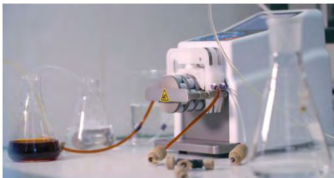
Dispositif de synthèse en flux continu.
