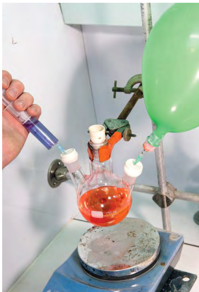
Montage de laboratoire pour réaliser une synthèse organique.
