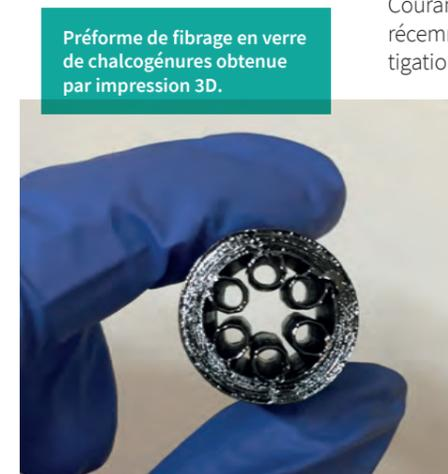
Préforme de fibrage en verre de chalcogénures obtenue par impression 3D.
